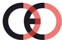
Falsche CE-Kennzeichnung (zu dicht)
